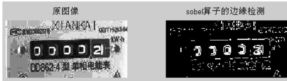
图 4.10 Sobel 边缘检测
